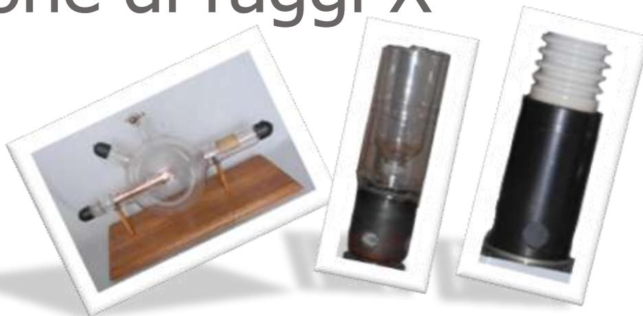
I raggi X si ottengono, tipicamente, bombardando, in condizioni di vuoto spinto, un bersaglio metallico con elettroni veloci emessi da un catodo riscaldato ed accelerati verso un anodo (bersaglio) positivo.
